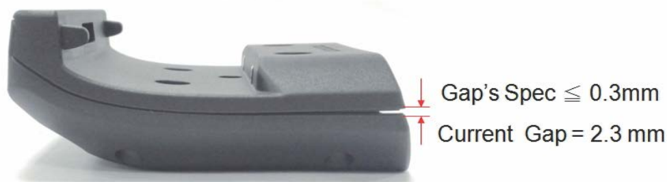
Фиг. 1 Деформацията в реалния продукт е 2.3 mm, което превишава зададената от конструкторите.
