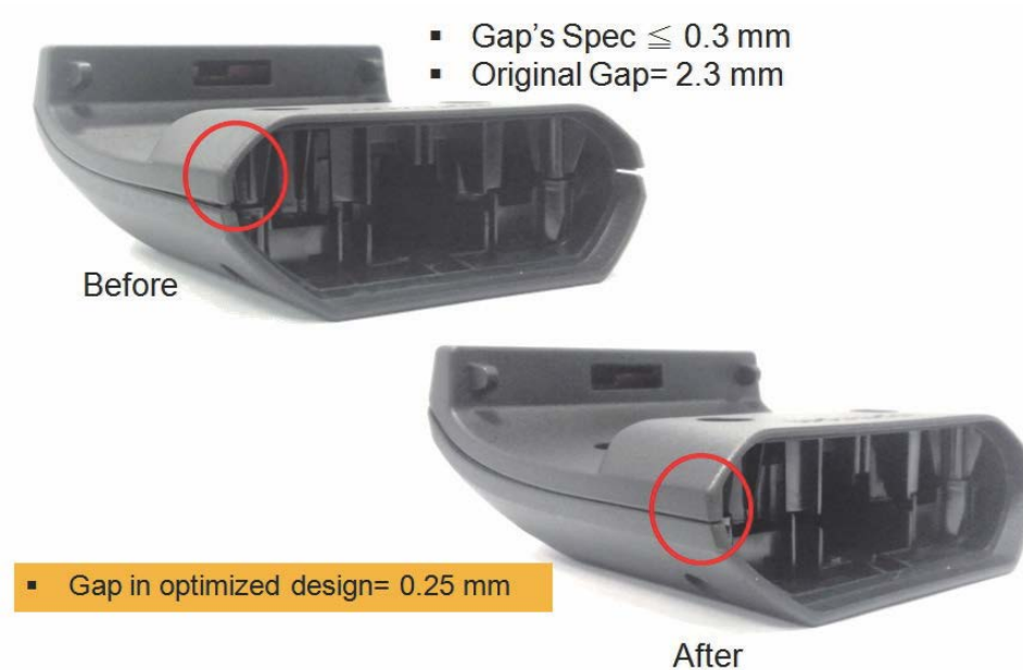
Фиг. 5 Снимката на реалната сборка с оригинална и оптимизирана хлабина
