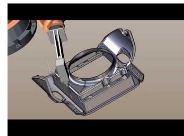
Програма за рязане на стъклопласт със SprutCAM Robot за KUKA робот
