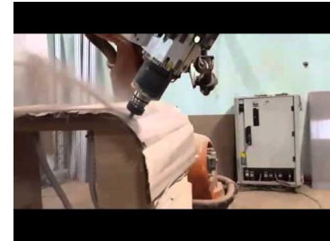
Режеща програма за мебели със SprutCAM Robot за KUKA
