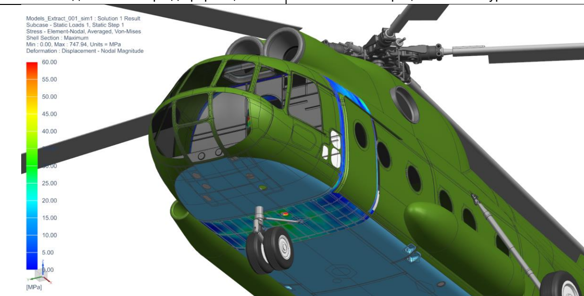
Симулация на участък от корпуса за оценка на въздействията при деформация
